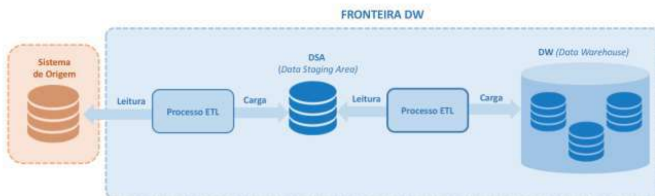
Figura 22 - Carga de dados do sistema de origem na DSA
